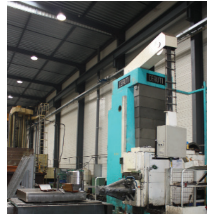
Aléseuse CN 5 axes CERUTI Capacité Machine 3500 x1500 x1000
