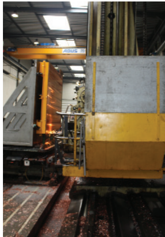
Aléseuse COLLET (Visus) Capacité Machine 12000 x 3240 x 2200
