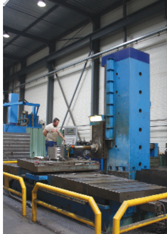
Aléseuse CN TOS 6 Axes Capacité Machine 3500 x 2000 x 1260
