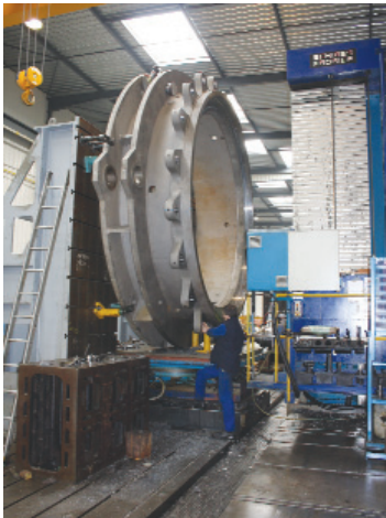
Aléseuse CN 5 Axes SCHIESS Capacité Machine 8700 x;3000 x 2000
